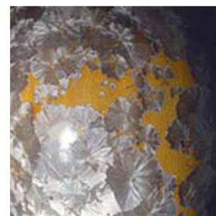
Температура на изпичане – 1185°C – 1210 °C. Задръжка – 1093°C 1 час; 1038 °C 3 часа.
