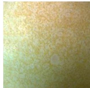
Температура на изпичане – 1220°C. Задръжка – 2 часа
