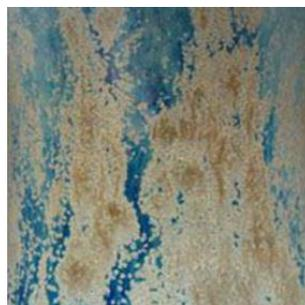
Температура на изпичане – 1070°C. Задръжка – 3 часа
