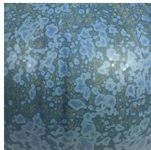
Температура на изпичане – 1270°C – 30 мин. Задръжка – 1050°C – 3 часа.
