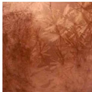
Температура на изпичане – 1185°C – 1220 °C. Задръжка – 1093°C 2 часа
