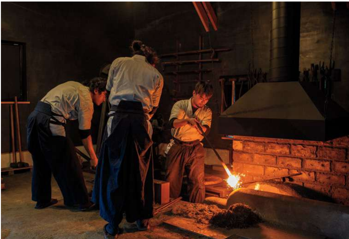
Мияги (вляво), Томоки Куромото (в средата) и Косуке Ямагзое (вдясно) си сътрудничат, докато коват, загряват и съхват парче стомана. Процесът, наречен танрен , заздравява метала.
