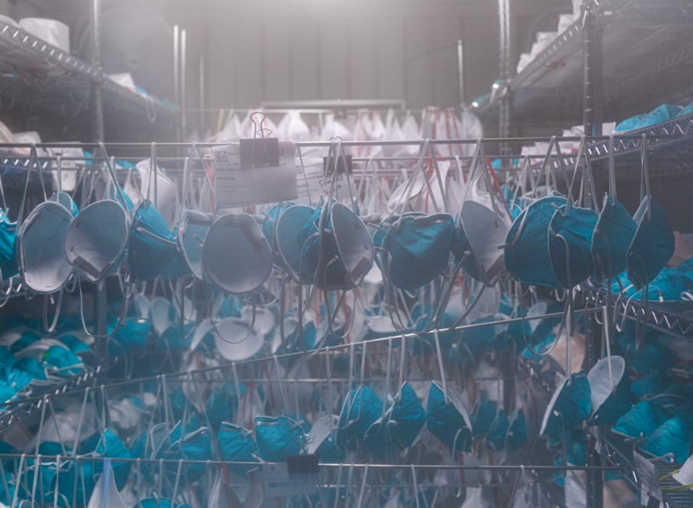
Маски N95 биват обеззаражавани в нова система, която позволява безопасното повторно използване на вещи за еднократна употреба. Разработена от организацията с идеална цел „Бател“ в Кълъмбъс, Охайо, системата използва vaporизиран водороден пероксид за процедура, която може да се приложи до 20 пъти на една маска. Вече се използва в десетки щати.
