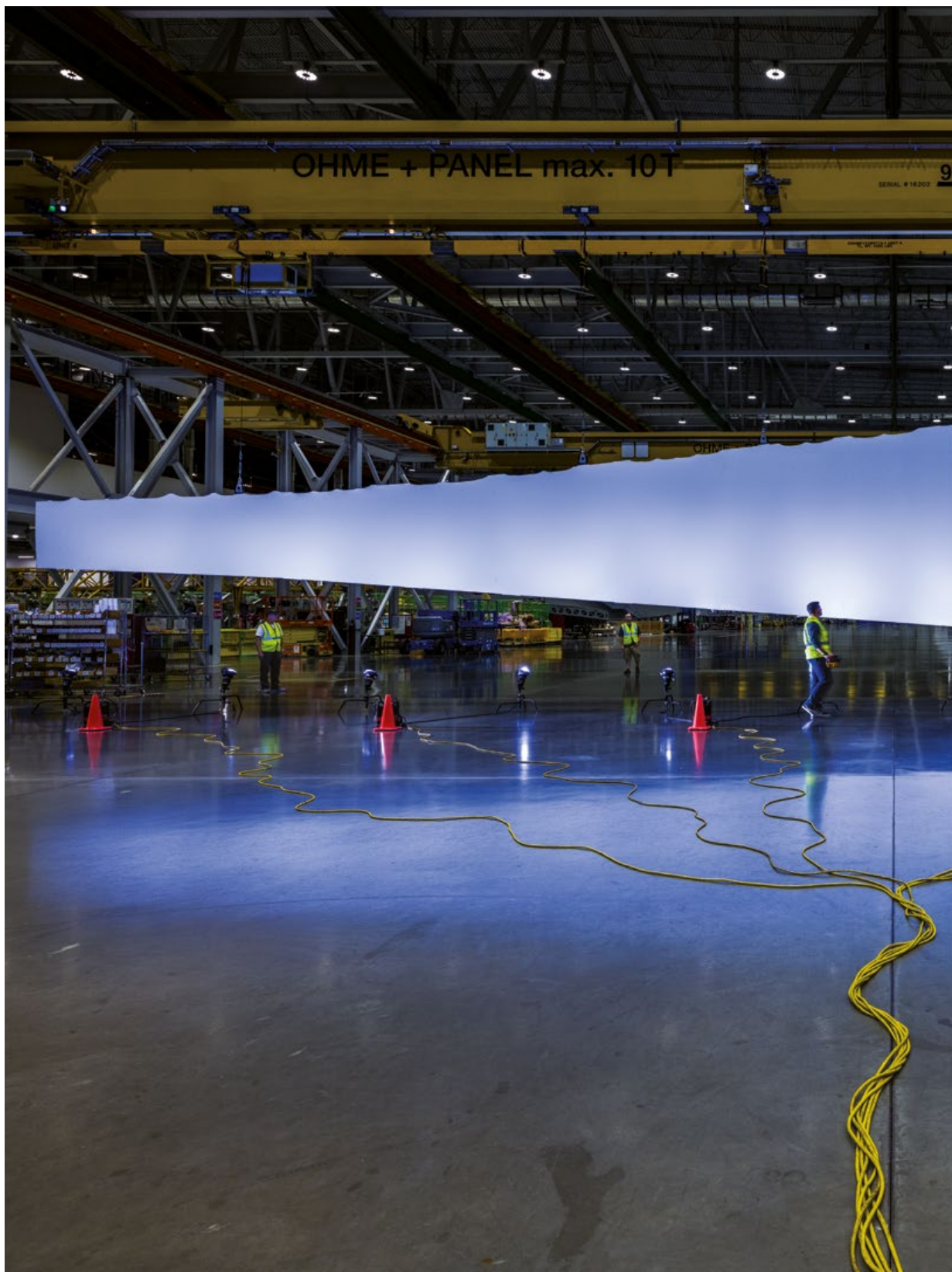
33,5-метров горен панел за крилото на новия модел 777X на „Боинг“ виси от козлови кран в базата им в Евърет, Вашингтон. Моделът 777X е с най-голям размах на крилете от всички реактивни самолети с дв
