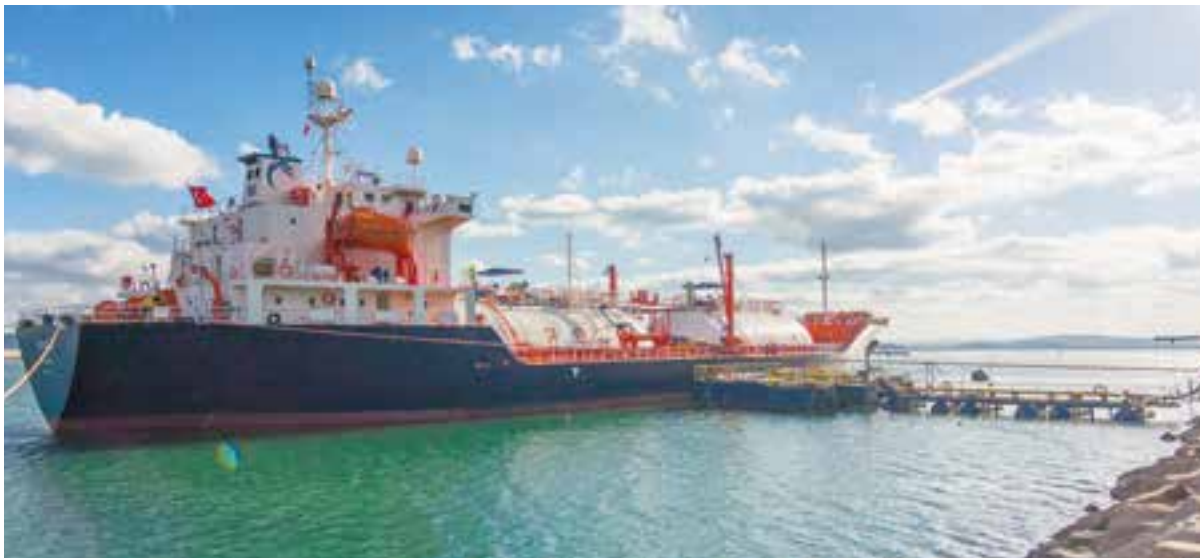
Танкерите се закотвят чрез понтон на отстояние от кея и чрез тръби се разтоварва Возеният от тях LPG
